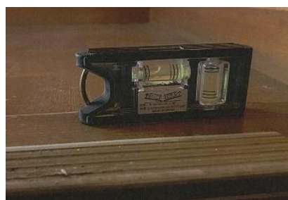
建物の傾き状況を水平器で測定
